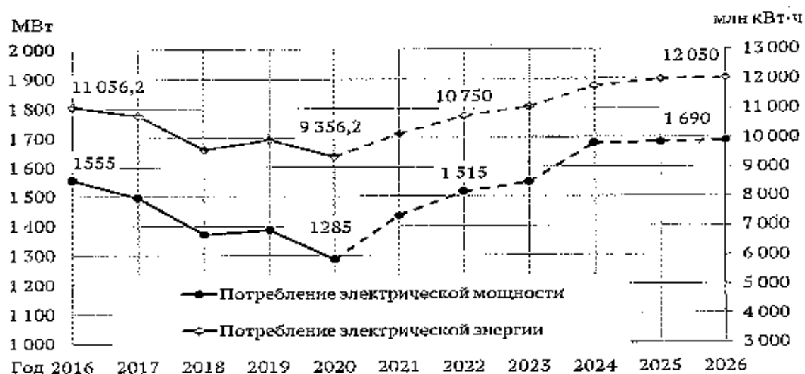
Схема 19. Динамика изменения потребления электрической мощности и энергии ЭЭС ЯНАО на 2016 – 2020 годы (факт) и 2021 – 2026 годы (базовый прогноз)
