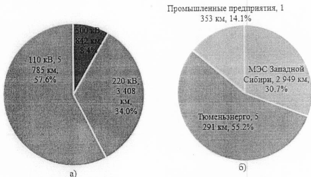
Схема 19. Структура ЛЭП 110 кВ и выше по протяженности по номинальному напряжению (а) и эксплуатирующим организациям (б)
