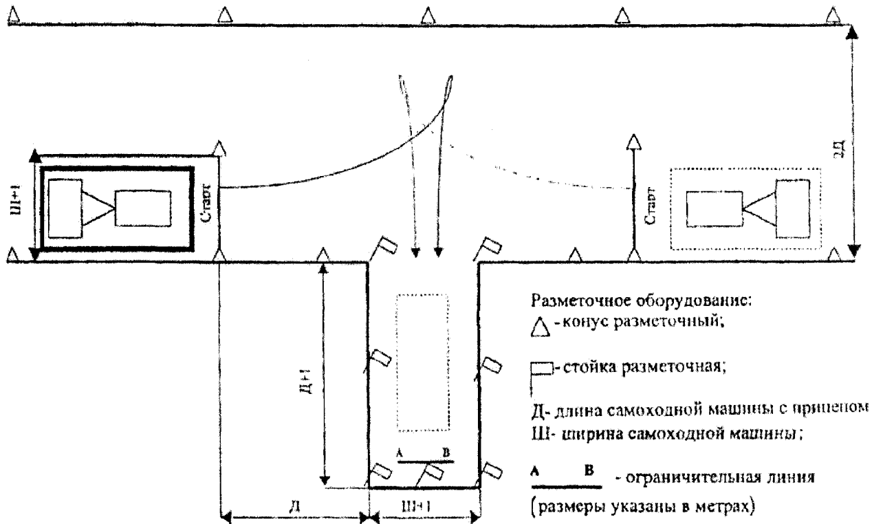
Схема 7. Постановка самоходной машины в агрегате с прицепом в бокс задним ходом
