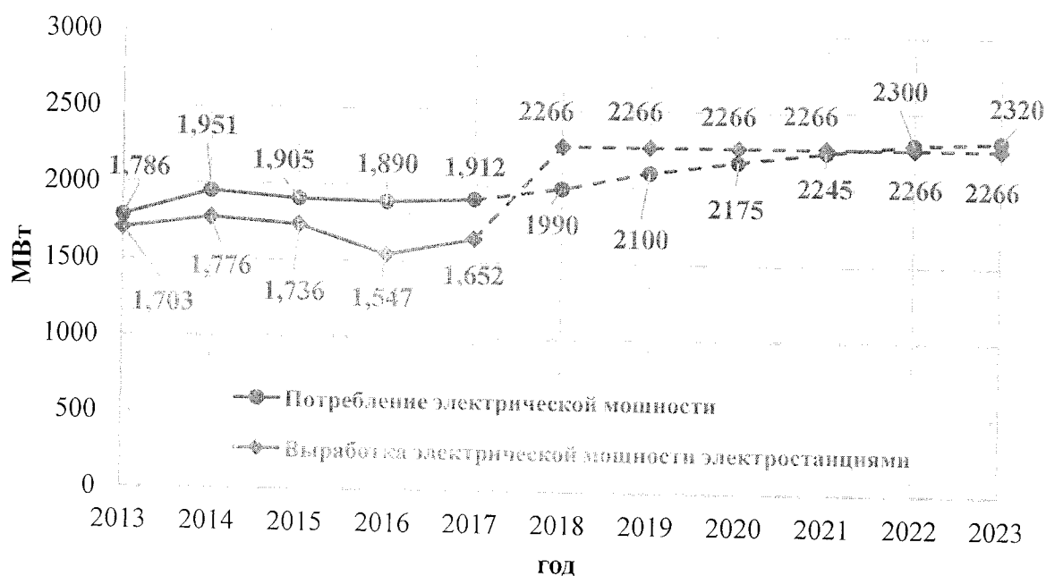
Рисунок 11 – Изменение установленной мощности электростанций и максимума нагрузки потребления по территории ЭЭС Тюменской области в период 2013 – 2023 годов
