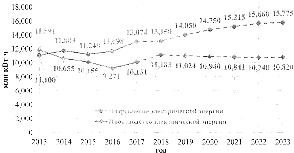
Рисунок 12 – Изменение выработки электростанциями и потребления электроэнергии по территории ЭЭС Тюменской области в период 2013 – 2023 годов
