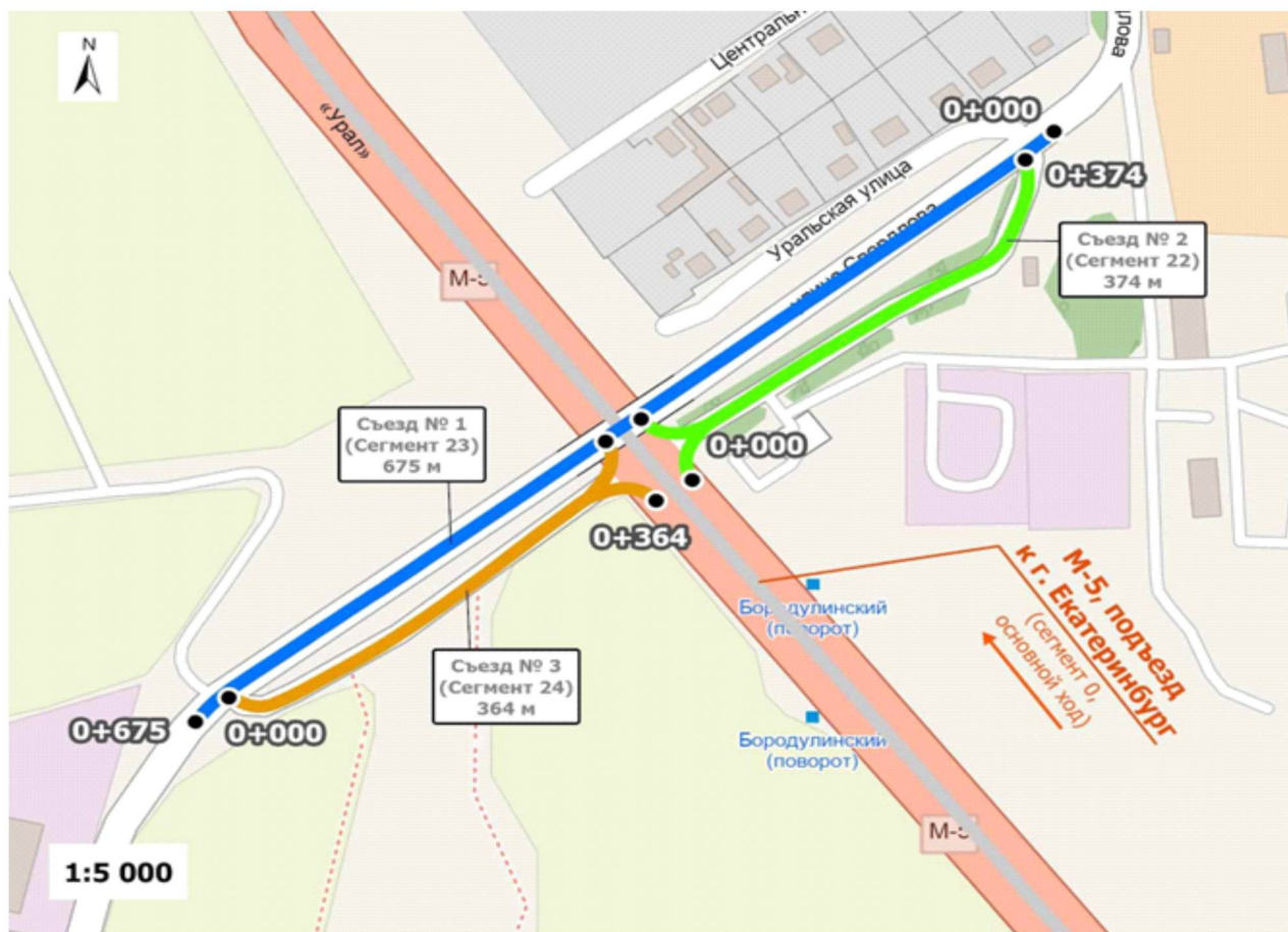
Рис. 1. Схема транспортной развязки на км 178+940 федеральной трассы М-5 «Урал»
