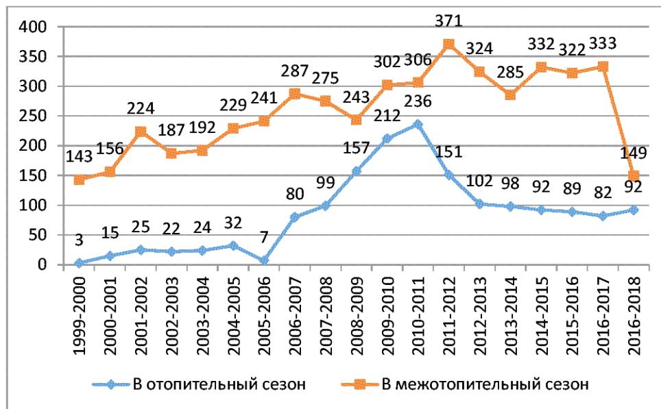
Рис. 17. Количество повреждений тепловых сетей обособленного подразделения «Свердловские тепловые сети» ООО «СТК»
