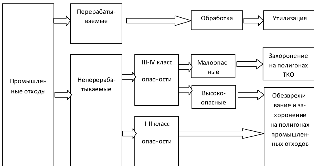
Рисунок 5.7.2. -Схема движения промышленных отходов
