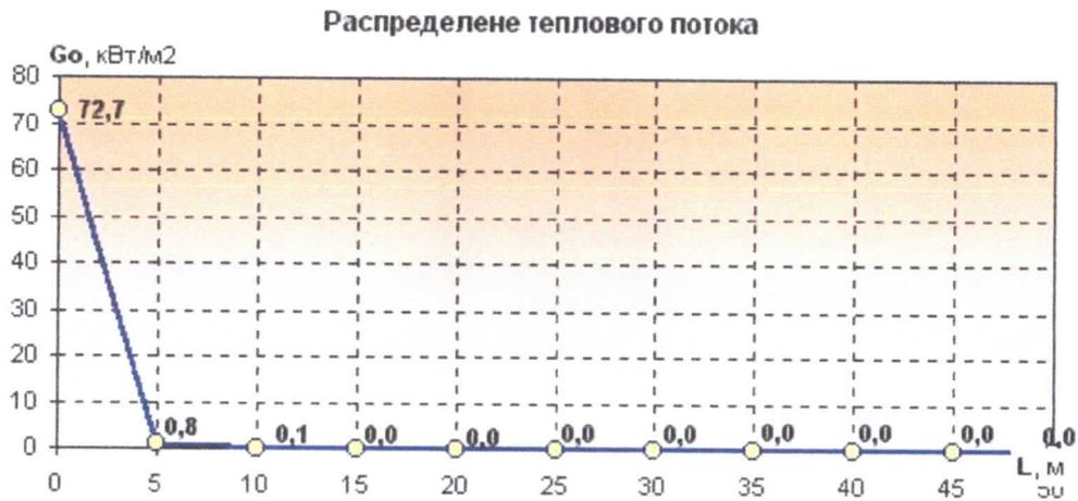
Рисунок 4.1.5. Распределение теплового потока при горении бензина и ДТ через горловину подземной емкости
