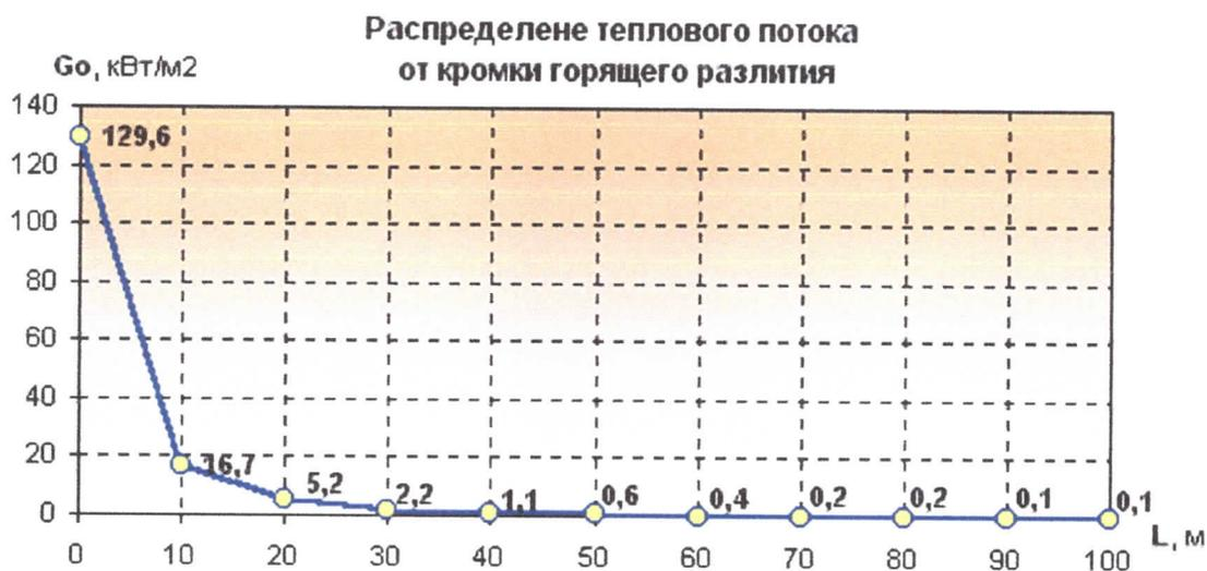
Рисунок 4.1.4. Распределение теплового потока при горении разлива бензина по сценарию АЗС-Рац
