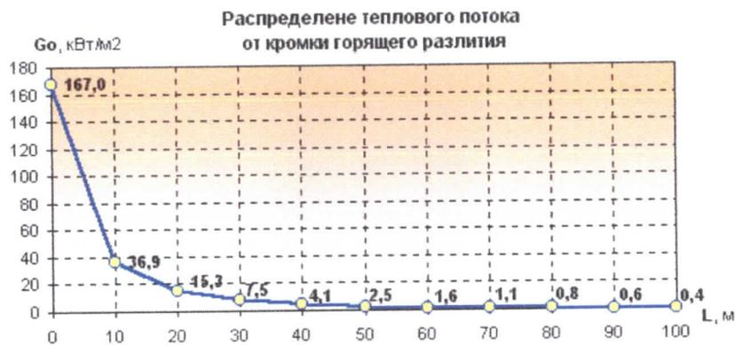
Рисунок 4.1.1. Величина теплового потока от кромки горящего разлива СУГ
