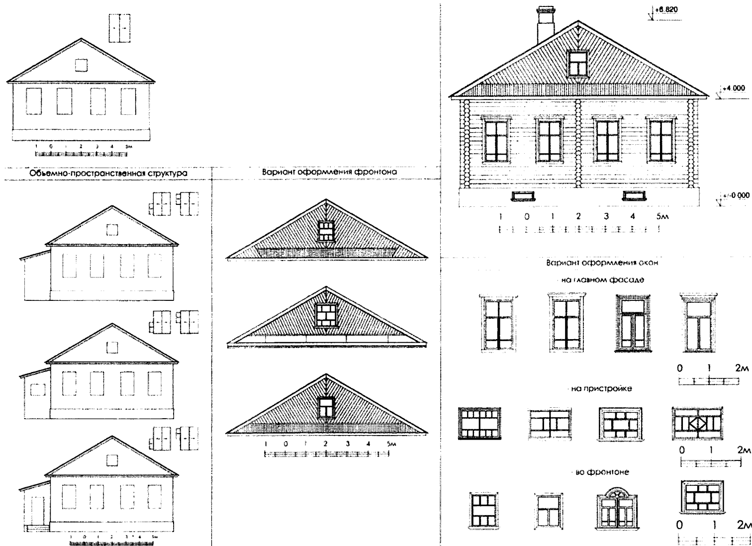
Тип Д 1.6. Деревянный бревенчатый одноэтажный в четыре окна по главному фасаду с двухскатной крышей.
