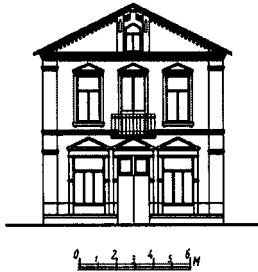
Тип 4.1 Двухэтажный каменный дом в три оконных оси с центральным входом с главного фасада и двускатной кров,
