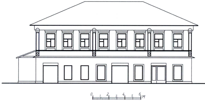
Тип 2 Двухэтажный полукаменный дом в восемь оконных осей с входами в первом этаже с центрального фасада
