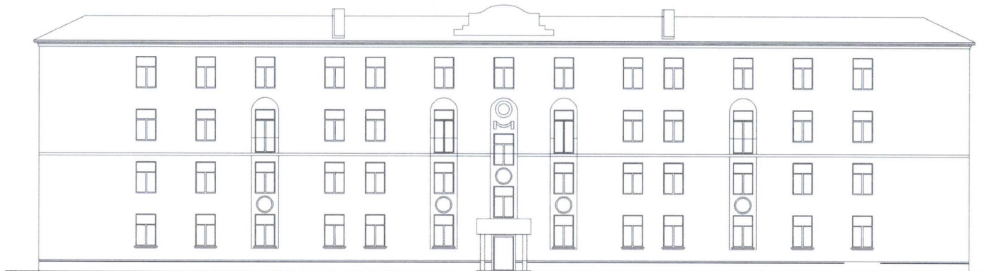
Тип 18 Четырехэтажный каменный жилой дом симметричного решения фасада с вальмовой кровлей и центральным входом
