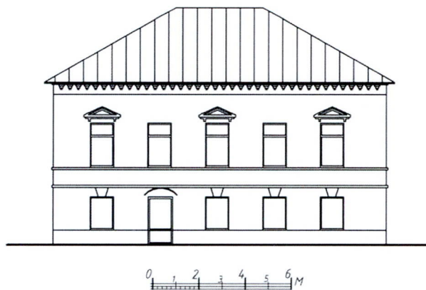
Тип 5.2 Двухэтажный каменный дом в пять оконных осей с вальмовой кровлей
