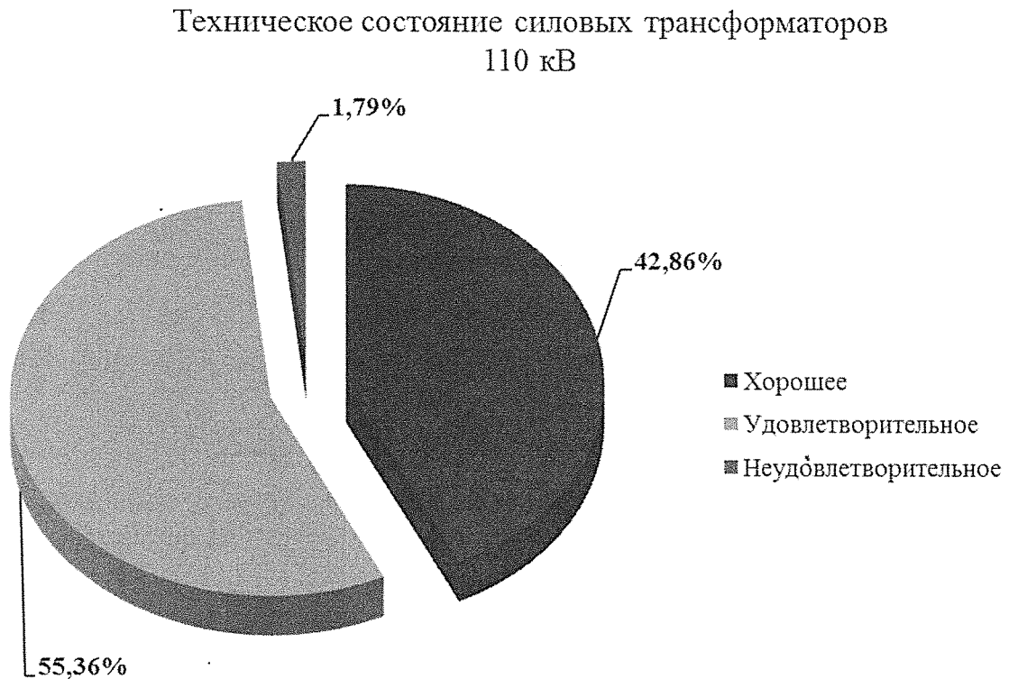
Рисунок 3.1. Техническое состояние силовых трансформаторов 110 кВ филиала ПАО «МРСК Центра» – «Белгородэнерго»
