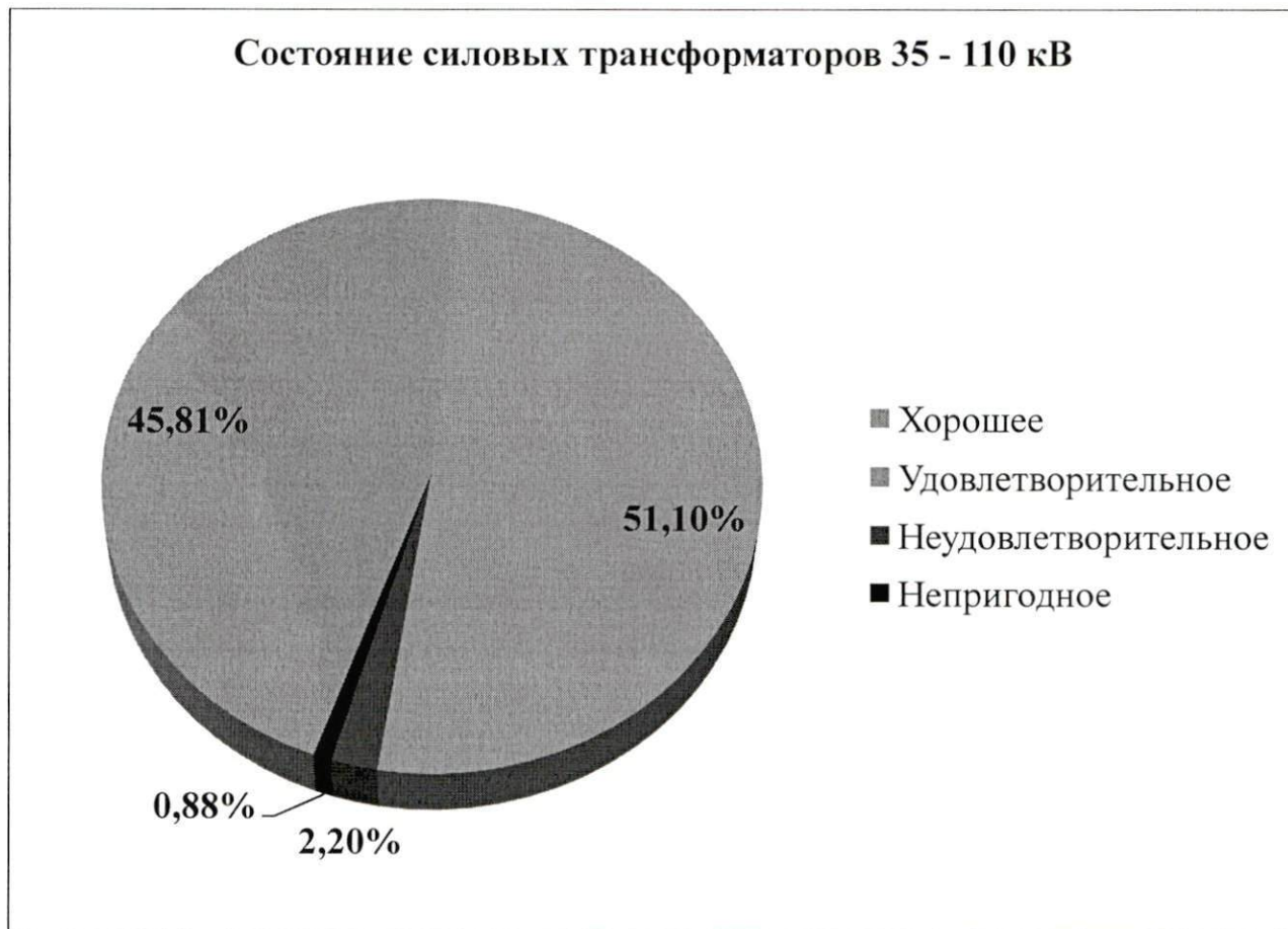
Рисунок 3.1. Техническое состояние силовых трансформаторов ПС 110 – 35 кВ филиала ОАО «МРСК Центра» – «Белгородэнерго», находящихся в эксплуатации более 25 лет
