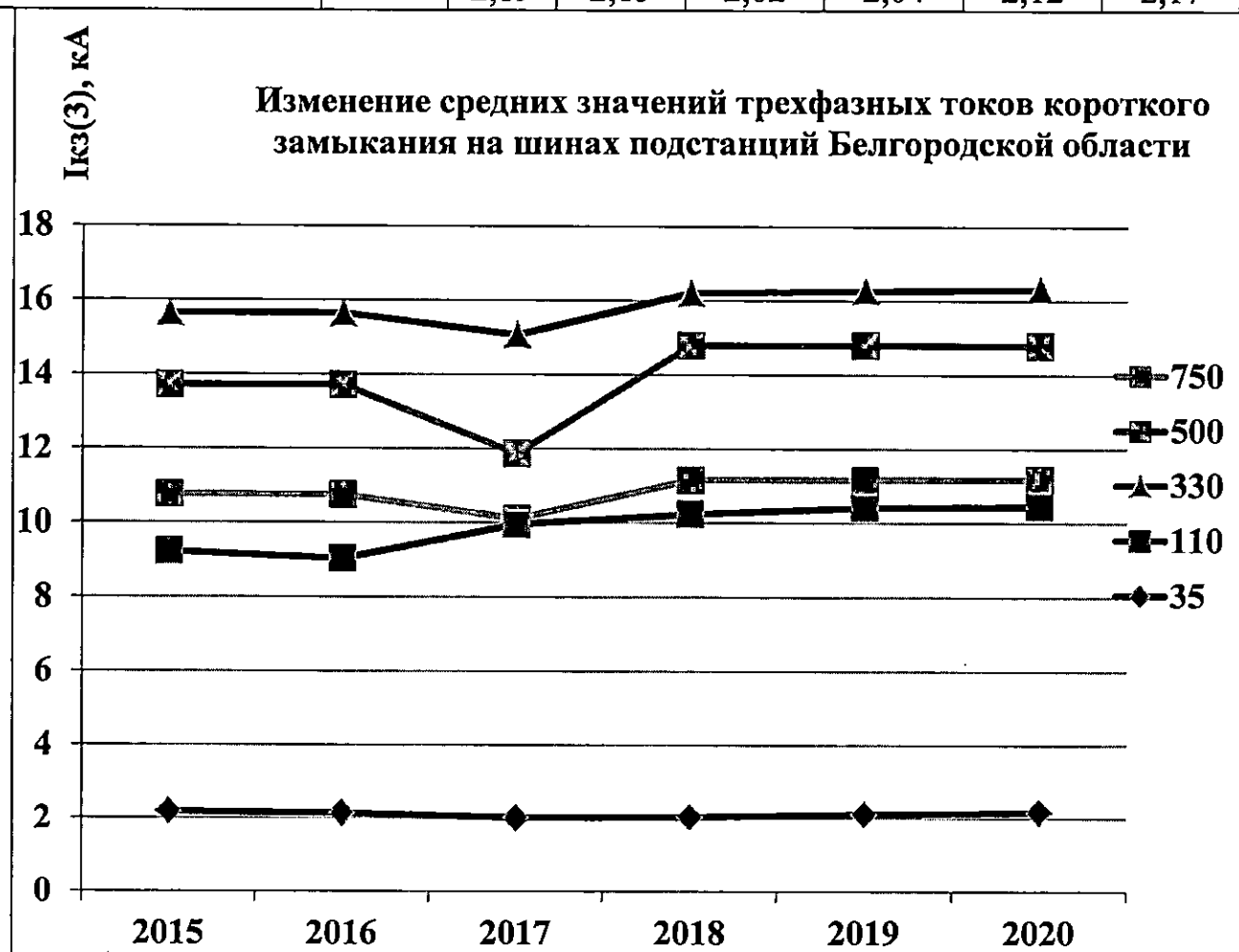
Рисунок 4.3. Изменения средних значений трехфазных токов короткого замыкания на шинах 35 кВ и выше подстанций Белгородской энергосистемы на 2015 – 2020 годы
