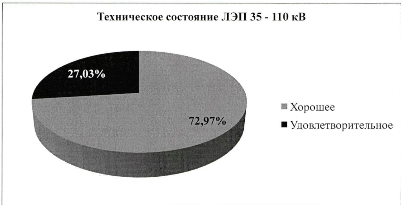
Рисунок 3.2. Техническое состояние ЛЭП 110 – 35 кВ филиала ОАО «МРСК Центра» – «Белгородэнерго», находящихся в эксплуатации более 40 лет
