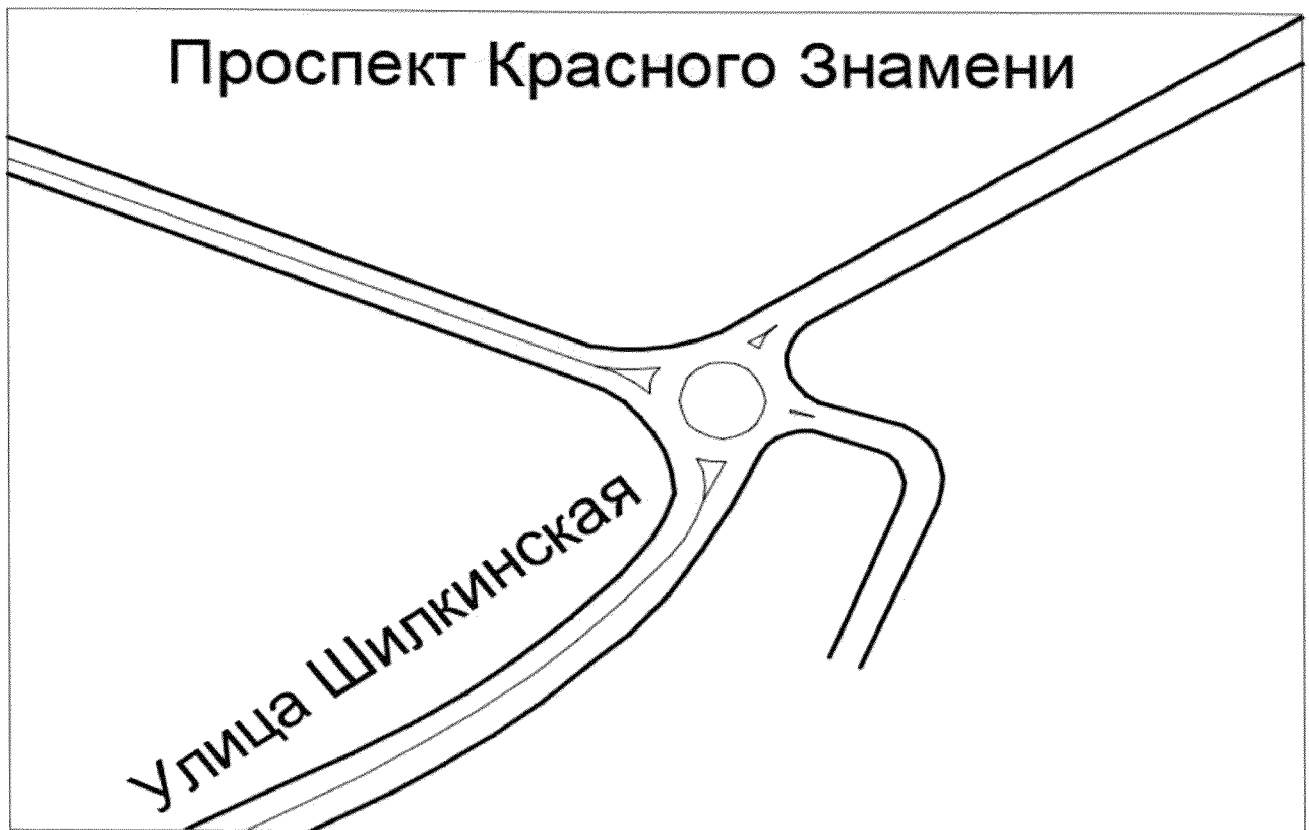
Рисунок 21 – Схема предлагаемого кругового движения в районе пересечения улицы Шилкинской и проспекта Красного Знамени
