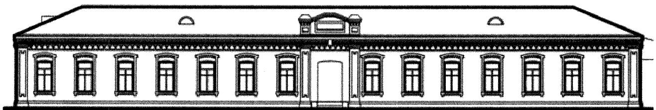
Композиционное построение – одночастное симметричное. Ось симметрии проходит по центру фасада и акцентирована оформлением входа в здание.
