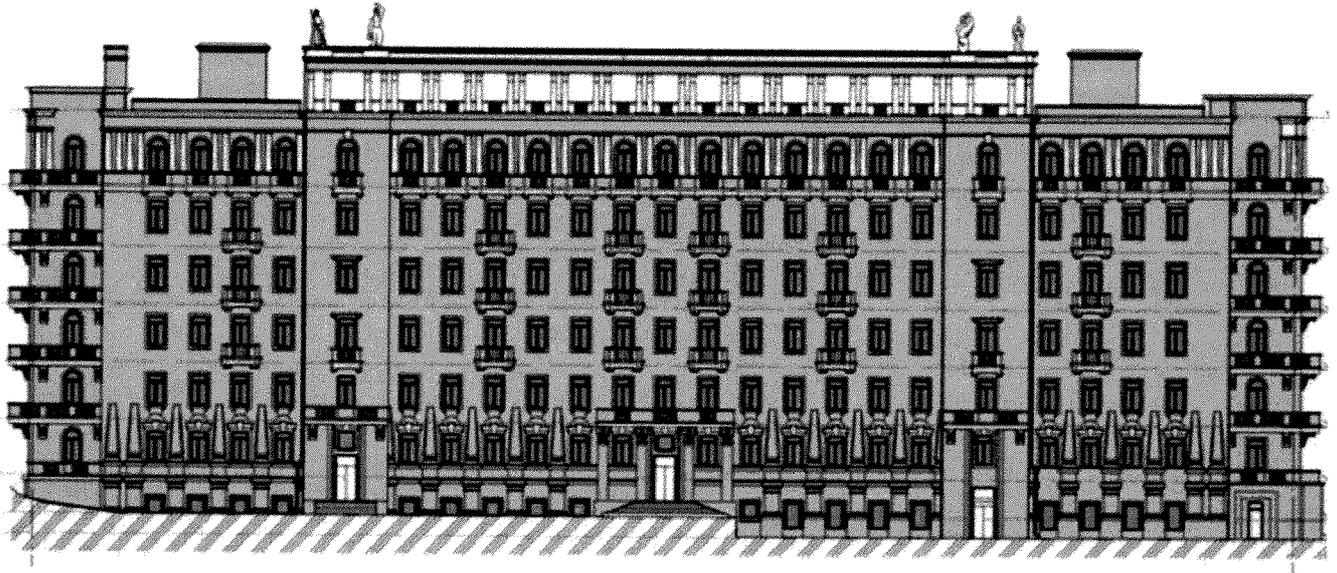
Композиционное симметричное построение образовано членением плоскости фасада по горизонтали двумя ризалитами и западающими угловыми простенками с равномерно расположенными балконами. По вертикали плоскость фасада условно расчленена на четыре уровня, имеющих различное архитектурное построение и декоративное оформление: цокольный и первый этажи, второй - пятый этажи, шестой этаж, кровельная часть.
