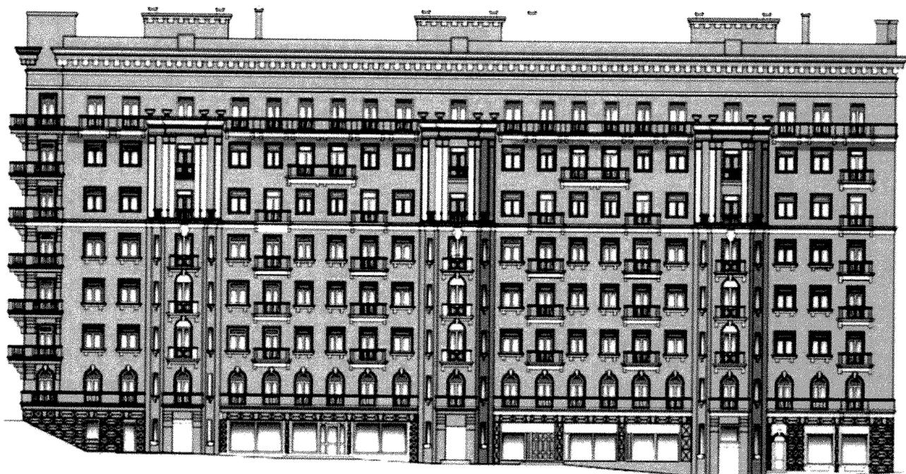
Композиционное построение образовано членением плоскости фасада по горизонтали тремя трехгранными эркерами и западающим левым угловым простенком с равномерно расположенными балконами. По вертикали плоскость фасада условно расчленена на четыре уровня, имеющих различное архитектурное построение и декоративное оформление.
