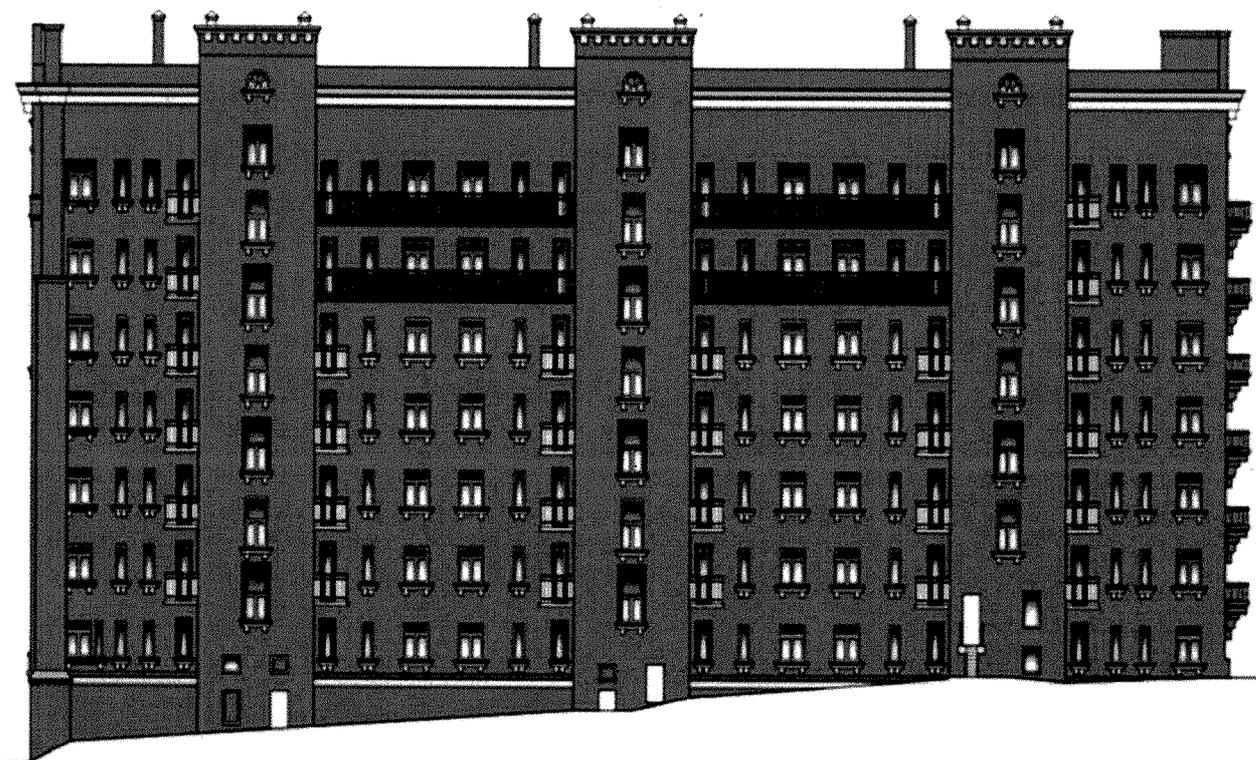
Композиционное построение образовано членением плоскости фасада по горизонтали тремя ризалитами, по вертикали - поясами и карнизом.
