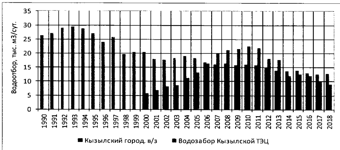
Рис. 2.3 Динамика изменения водоотбора на Кызылском городском водозаборе (ООО «Водоканал») и водозаборе АО «Кызылская ТЭЦ»
