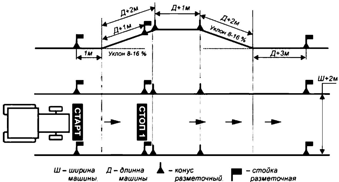
**Маневр 2 «Разворот при ограниченной ширине территории при одноразовом включении передачи (кроме гусеничных учебных самоходных машин и колесных учебных самоходных машинах с бортовыми фрикционами)».**
