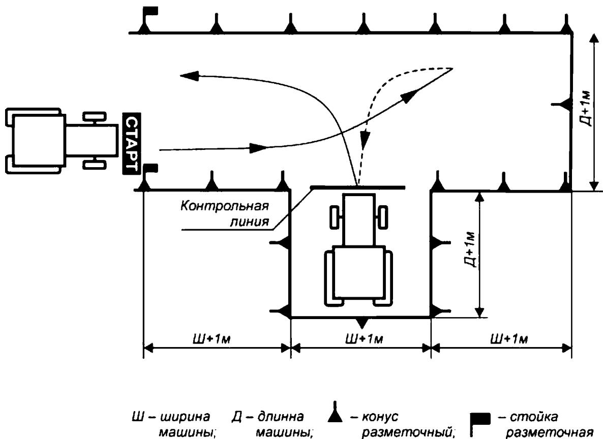
**Маневр 4 «Постановка учебной самоходной машины в агрегате с прицепом в бокс задним ходом» (кроме категорий «А», «А IV» и «F»).**
