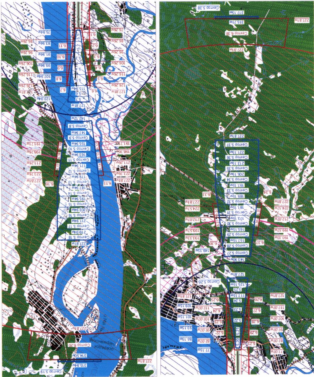
Схема секторов с указанием ограничения по высоте строительства объектов в пределах поверхностей взлета и захода на посадку М 1:50 000
