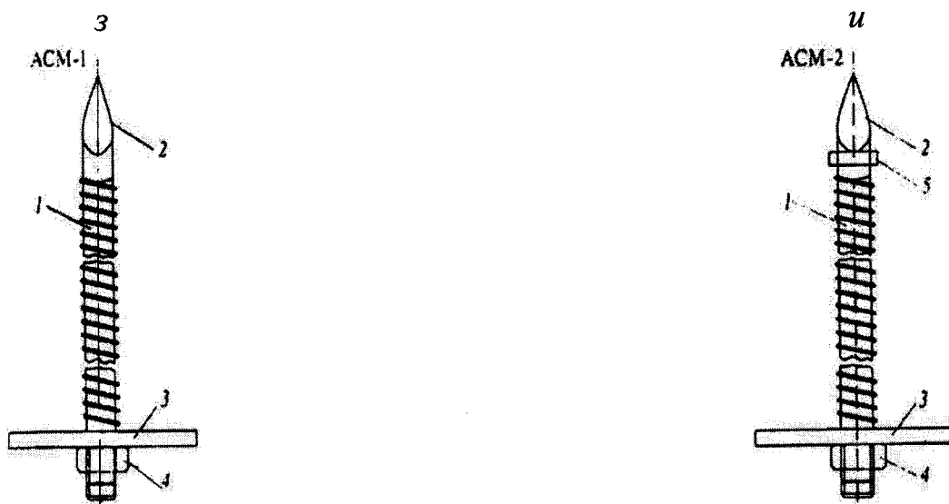
Рис. 13. Общий вид анкеров, в том числе применяемых для крепления ампулами с минеральной композицией:
