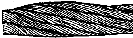
Рисунок 13. Местное увеличение диаметра каната
