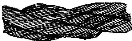
Рисунок 1. Обрывы и смещения проволок каната крестовой свивки
