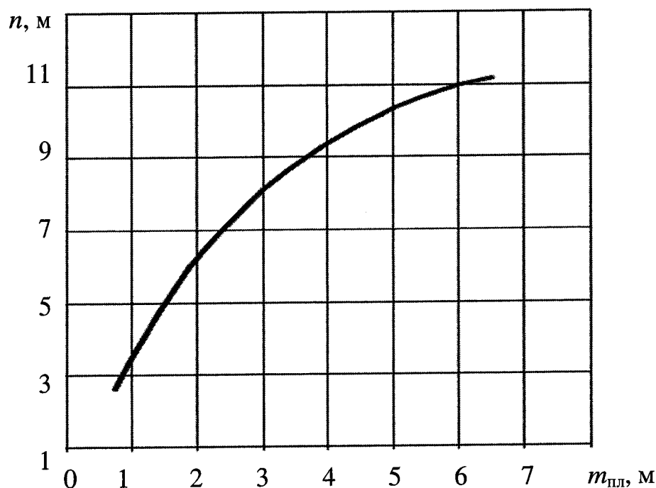
Рис. 3. Номограмма для определения ширины защитной зоны в краевой части угольного пласта
